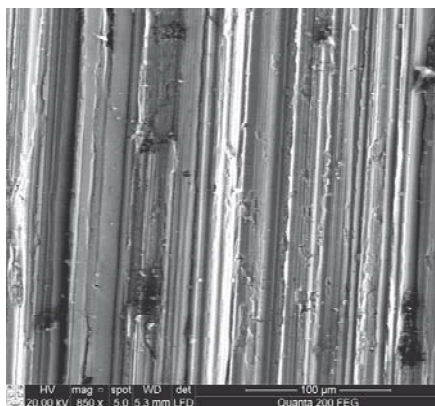
4 pav. Apvirinto sluoksnio (672 mėginys) SEM vaizdas ( \times 850 ). Fig. 4. Welded layer (672) SEM view ( \times 850 ).
